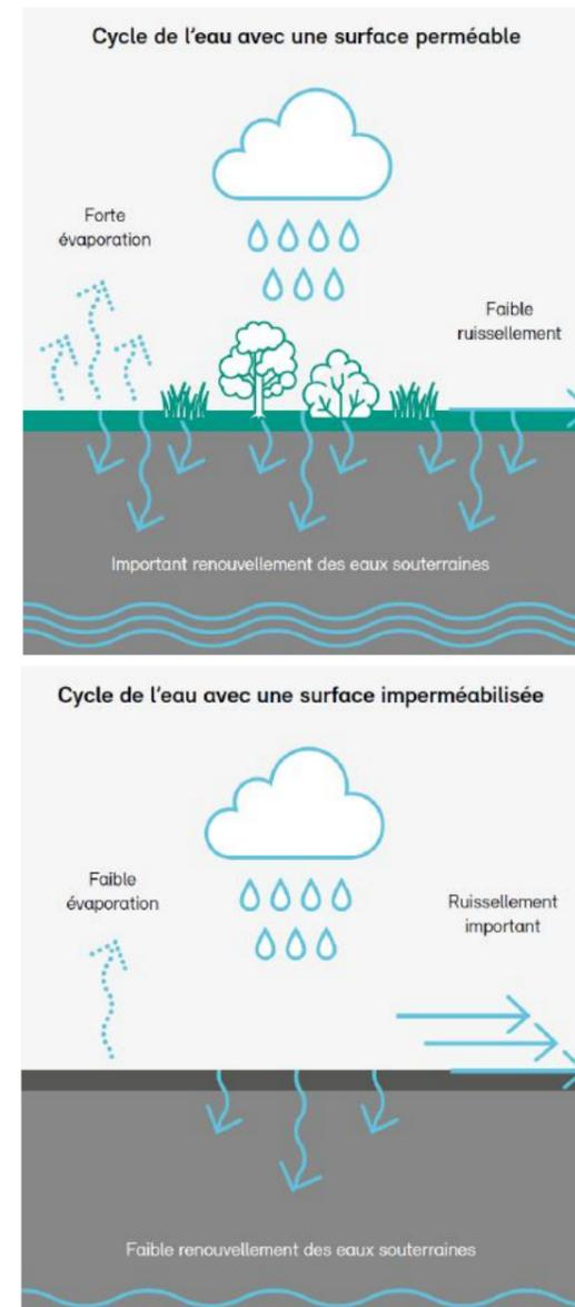
Figure 17 : Cycle de l'eau avec ou sans imperméabilisation du sol. Source : OFEV, Eau de pluie dans l'espace urbain, 2022.
