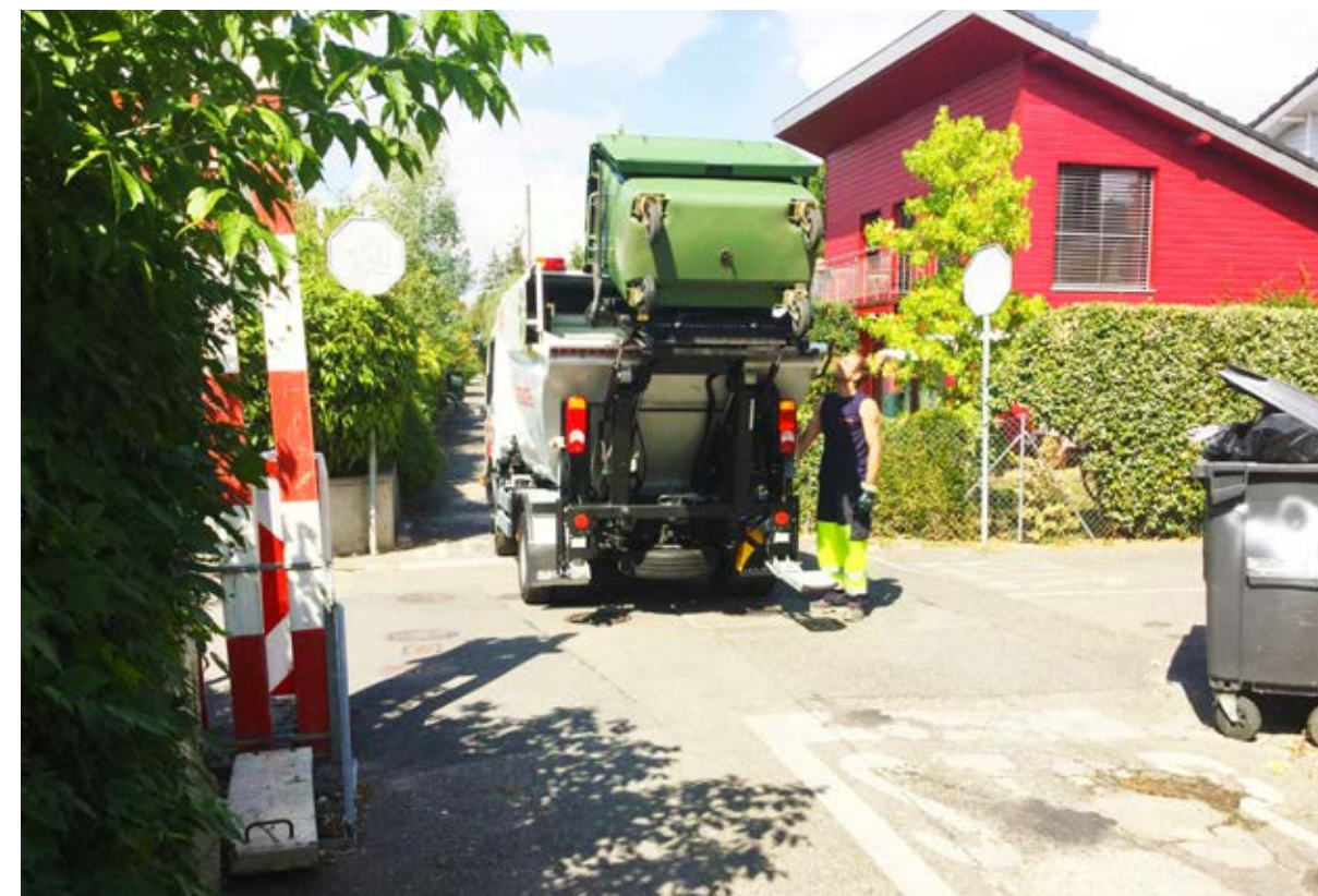
Nouveau en 2016 — Un mini-camion voirie équipé de deux essieux et d'un basculeur hydraulique pratique pour résoudre les problèmes d'accessibilité rencontrés sur le terrain | © DR
